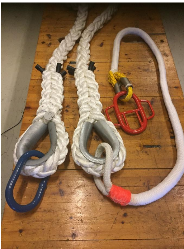
Forløper med Dextron-tau mellom nylontauet og løkken med håndtak
