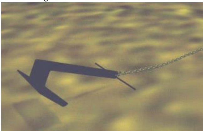
Figur 5: EH ploganker i startfase av strekktest
